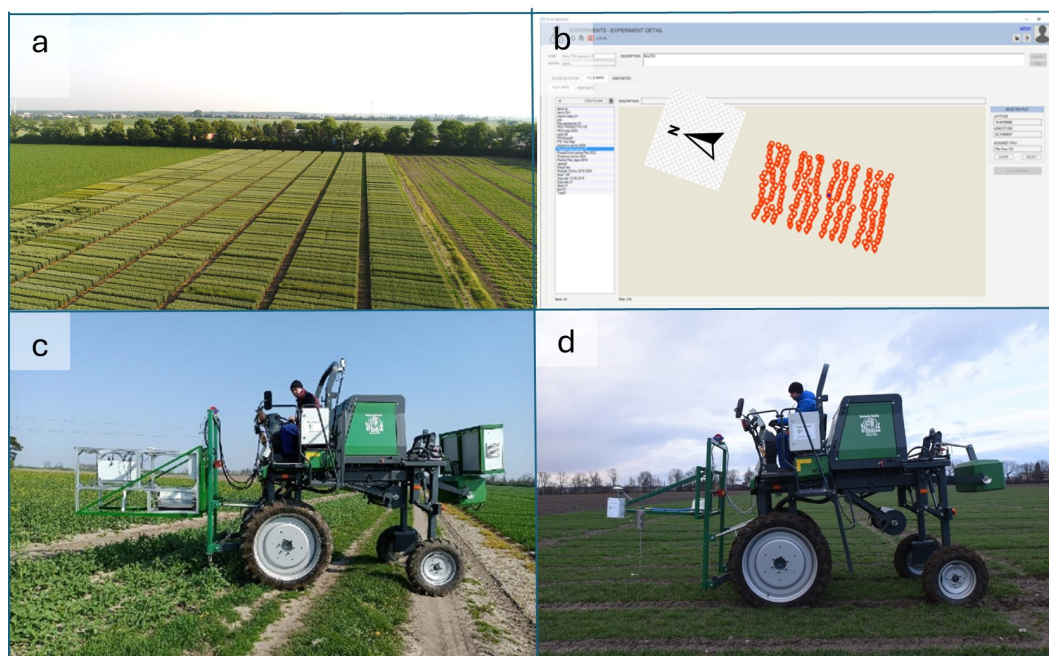
Rys. 2. System FieldScreen (PSI) zamontowany na nośniku narzędzi Zurn 540, (a) widok pól doświadczalnych, na których prowadzono fenotypowanie RGB; (b) fragment mapy pola z zaplanowanymi miejscami robienia zdjęć. Strzałką zaznaczono kierunek północny; (c) wjazd na pole przez pas obsiewu; (d) fenotypowanie zagęszczenia lanu.
